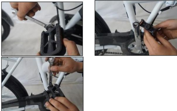
Figura 4 – Montaggio dei pedali.
