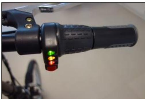
**Figura 17 – Visualizzatore del livello di carica della batteria.**
