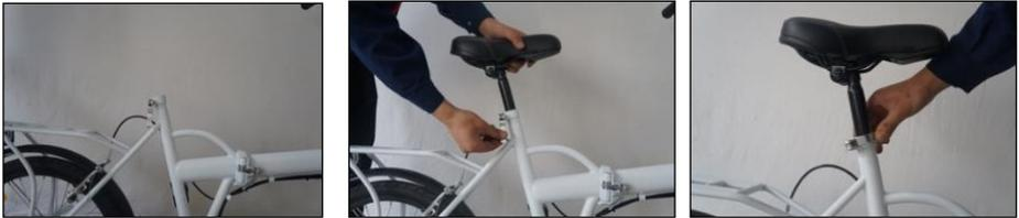
Figura 6 – Montaggio e regolazione della sella.
