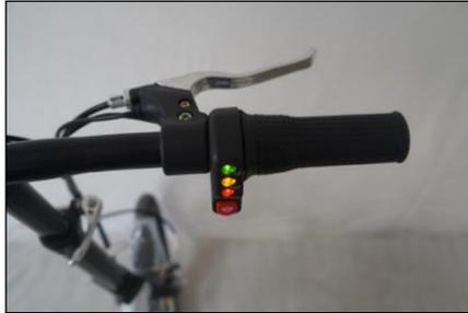
Figura 11 – Led visualizzazione carica batteria e accensione.
