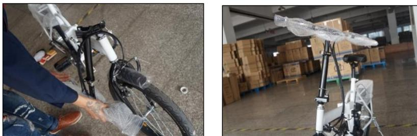
Figura 5 – Montaggio del manubrio della bicicletta.
