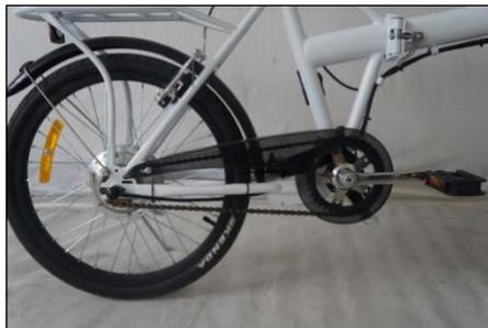
Figura 12 – Carter di protezione della catena di trasmissione.
