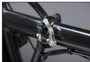
Figura 2 – Apertura e fissaggio del telaio.
