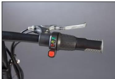
Figura 9 – Manopola dell'acceleratore.
