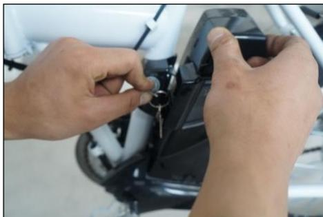
**Figura 16 – Estrazione della batteria dalla propria sede.**
